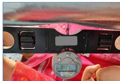
检测凹陷程度为7.2%，现场验证实测凹陷变形量为5.2%（回弹）
