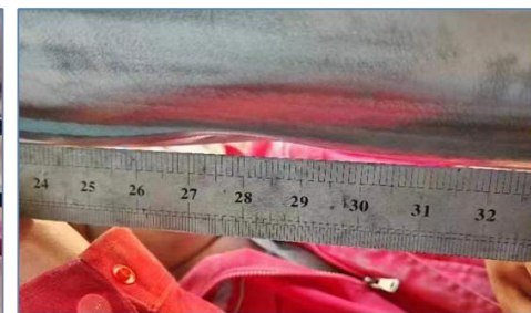
检测凹陷程度为7.2%，现场验证实测凹陷变形量为5.2%（回弹）
