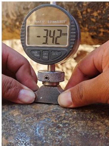
检测腐蚀程度为68%，现场验证实测68.4%
