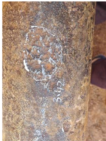
检测腐蚀程度为68%，现场验证实测68.4%
