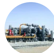
超音速脱水 脱烃设备
